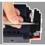
Setzen Sie den Chip in den Chipschlitz der neuen Patrone ein
